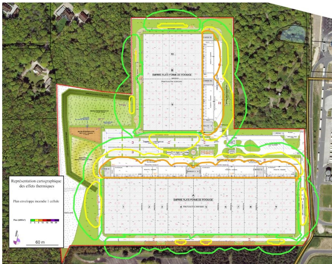
Les modélisations incendie ont mis en évidence un risque de propagation aux cellules adjacentes (durée d'incendie de certaines cellules supérieure à la tenue au feu de certains murs séparatifs). Notons cependant que le logiciel de modélisation ne tient pas compte de la sollicitation réelle des murs séparatifs aux agressions thermiques (agression de la paroi dès la 1<sup>ère</sup> minute d'un incendie) ainsi que des dispositifs d'intervention.
